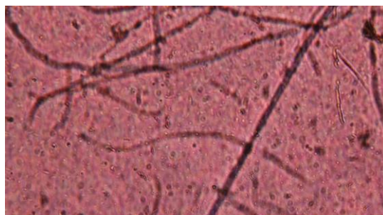
Fig. 16 Crepe su pellicola in poliestere a ~ 20 anni dall'esposizione (microfotografia R. Morbidelli).
