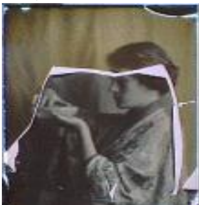
Fig 20 Decadimento e scollamento dello strato di gelatina da lastra fotografica. (© Nederlands fotomuseum, Rotterdam)
