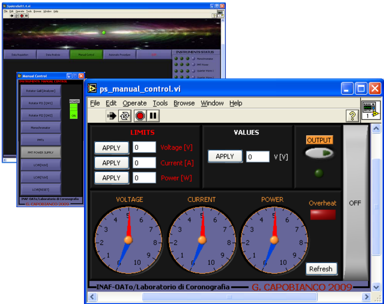
Fig. 4.2.17 – Controllo Manuale del power supply
