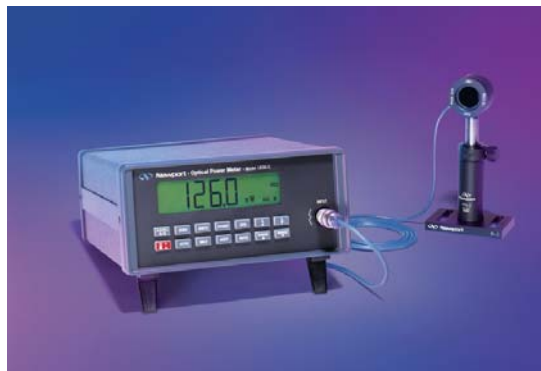
Figura 2. Il power meter Newport 1830-C con detector Newport 818-SL [2].
