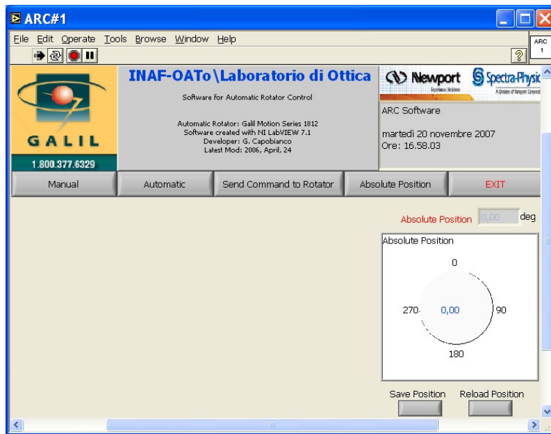
Figura 9. Pagina iniziale del software di controllo del rotatore 1.
