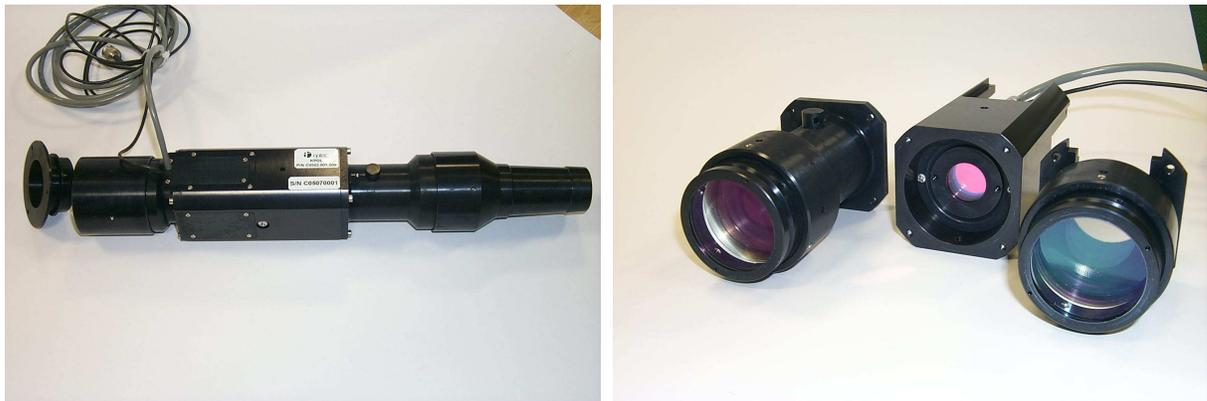
Figura 3 (Sinistra) K-corona polarimeter (KPol) utilizzato per i tests. (destra) Il KPol è basato su cristalli liquidi che possono modulare elettro-otticamente l'immagine coronale polarizzata
