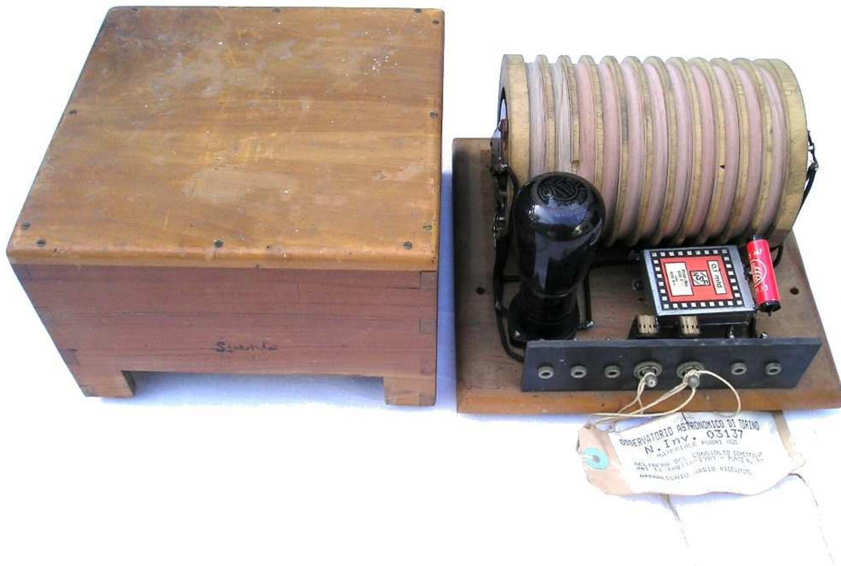
Apparecchio Radioricevitore a bobina di ebanite - anteriore al 1926
