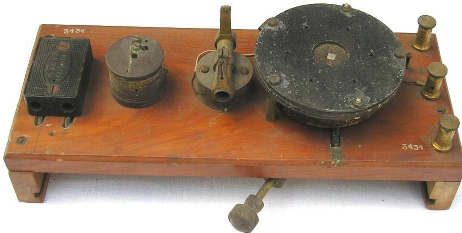
Ricevitore a grande membrana 4000 ohm - anteriore al 1925
